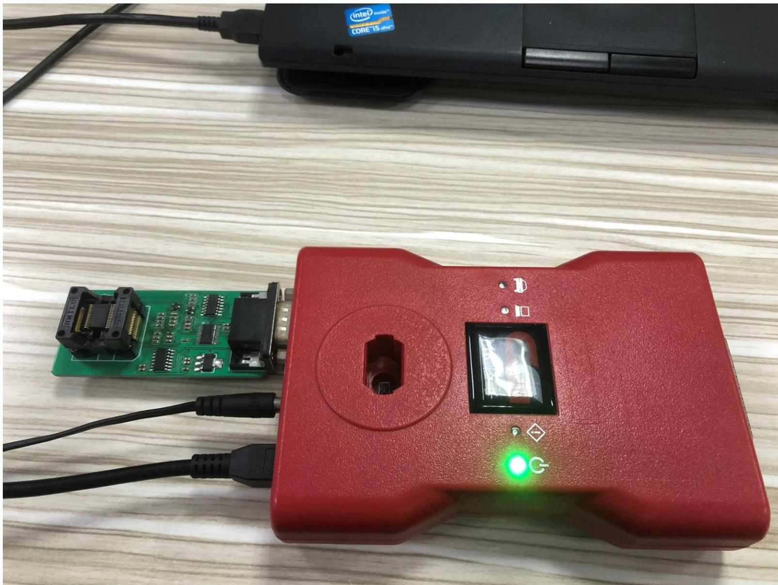
3. 将NEC芯片清洗干净，夹入ELV修复适配器并插上设备。
